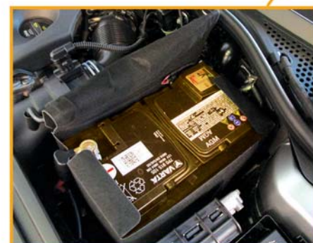
12V-Batterie im Motorraum Bei Verbau der 12V-Batterie im Motorraum entfällt die 12V-Batterie in der Reserveradmulde.
