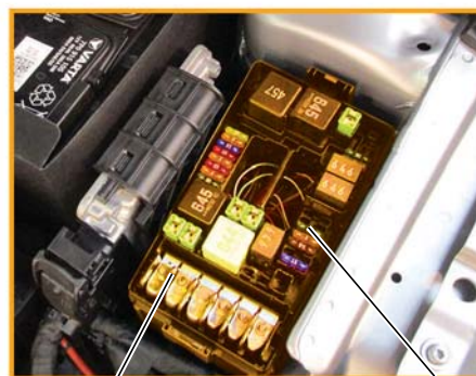
Multifuse-Vorsicherungshalter SA auf dem Relais- und Sicherungsträger SR1
